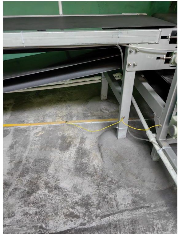
传动电动机机架接地线已改为并联，传动机架之间接地线已连接
