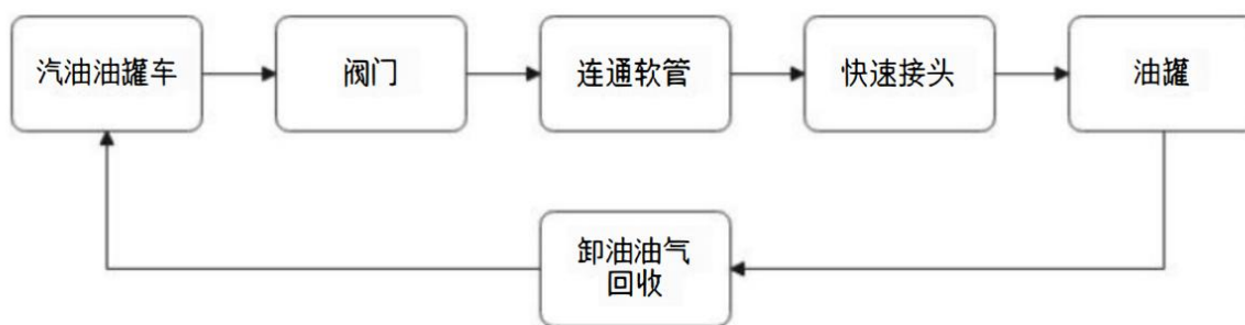
图 2.2.5-1 汽油卸油工艺流程示意图
